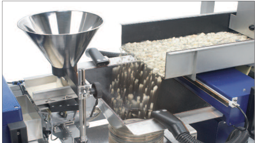
HAYER CPA 4-2 bei der Vermessung von Kies und Sand in zwei Messbereichen
