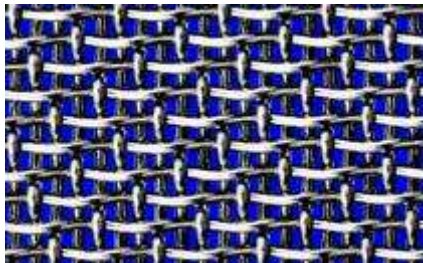
Köperbindung, 5-bindig, ECLA 5 Atlaskörper
