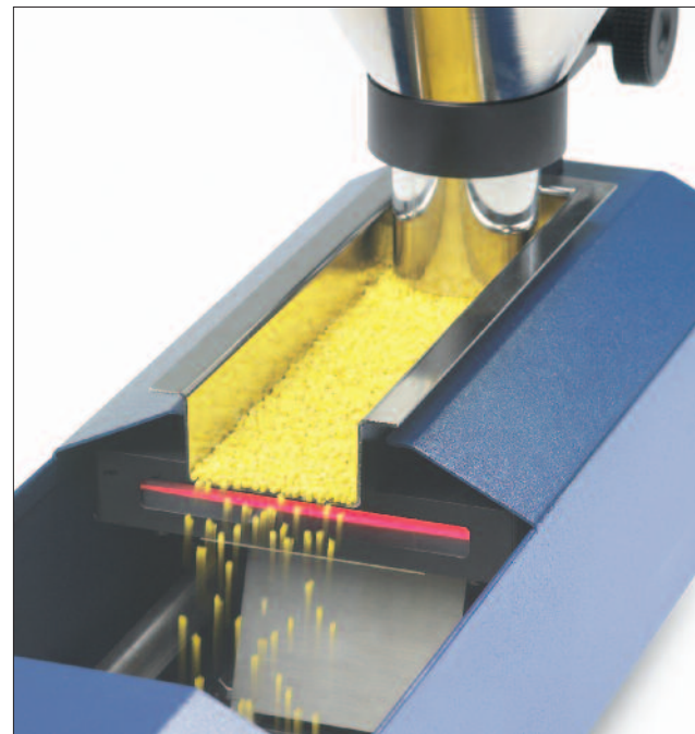
HAVER CPA 2-1 bei der Vermessung von Kunststoffgranulat
