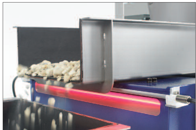
HAVER CPA 4-1 bei der Vermessung von Kies
