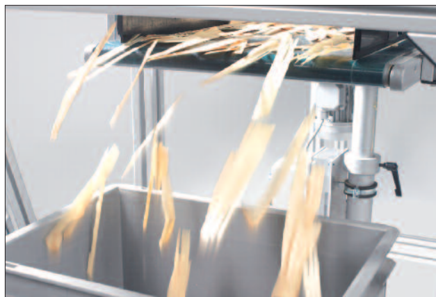
HAVER CPA 4 CONVEYOR bei der Größen- und Formanalyse von Holzhackschnitzeln
