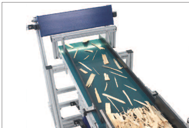
HAVER CPA 4 CONVEYOR, Ausrichtung und Vereinzelung von länglichem Probenmaterial auf dem Förderband
