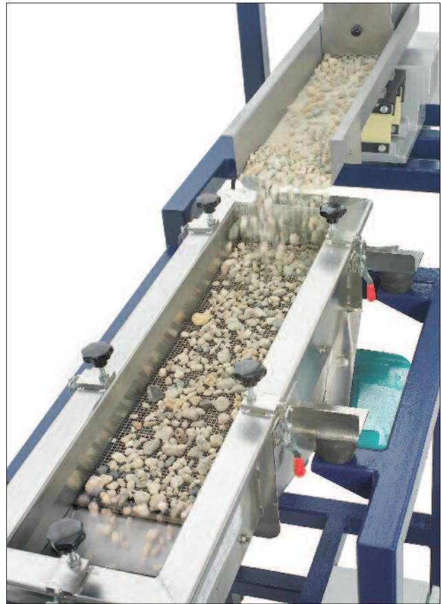
HAVER DMS Siebmaschine, kombiniert mit HAVER EMZ Förderrinne, bei der Vorabsiebung von Sand und Kies
