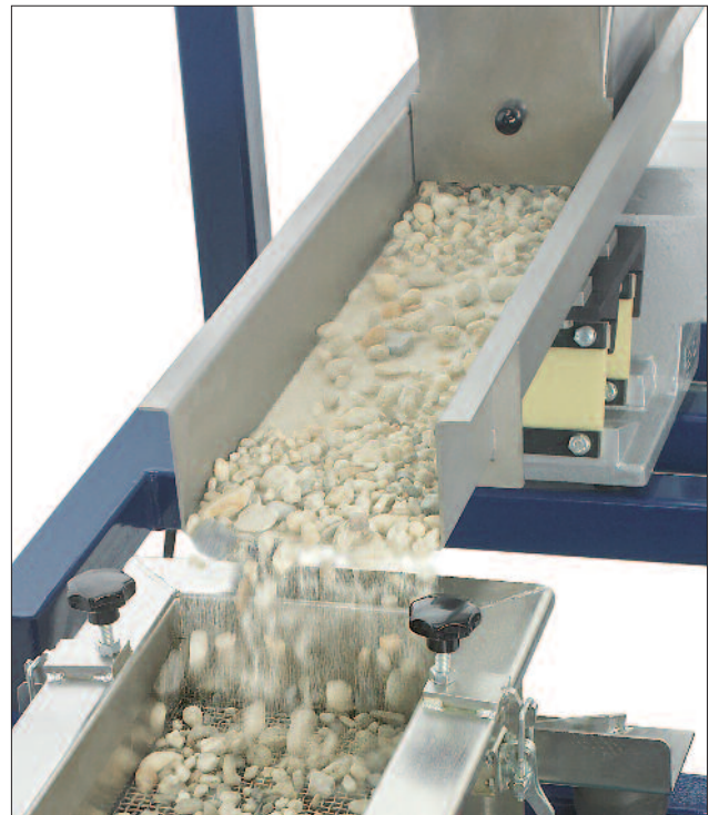
HAVER EMZ Förderrinne bei der Dosierung von Kies und Sand
