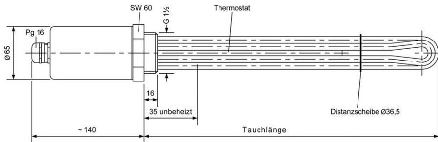
**Sonderanfertigung** Andere Längen, unbeheizte Zonen, Leistungen, Spannungen und Werkstoffe z. B. Rohrheizkörper aus Edelstahl W.-Nr. 1.4541, 1.4571, 1.4828, Nippel G 1 1/2 aus Edelstahl, G 2 aus Messing und Schutzart IP 65, sind lieferbar.
