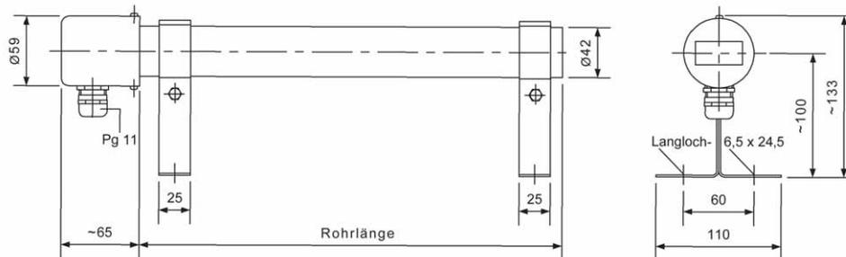
**Aufstellung** Wie Rippenrohr-Heizkörper, waagrecht oder senkrecht möglich. Bei senkrechter Montage muß der Anschluss unten liegen.
