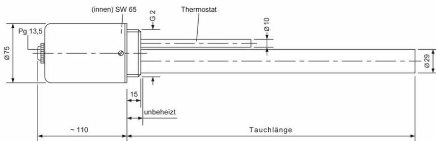
**Sonderanfertigung** Andere Längen, unbeheizte Zonen, Leistungen, Spannungen, Werkstoffe, z. B. Edelstahl W.-Nr. 1.4571, Haube mit radialer, um 360° schwenkbarer Kabeleinführung in Schutzart IP 30, Haube Schutzart IP 65 und Thermostat 100 bis + 190° C, Schaltdifferenz 5 K (3 K), 16 A bis 400 V, lieferbar.
