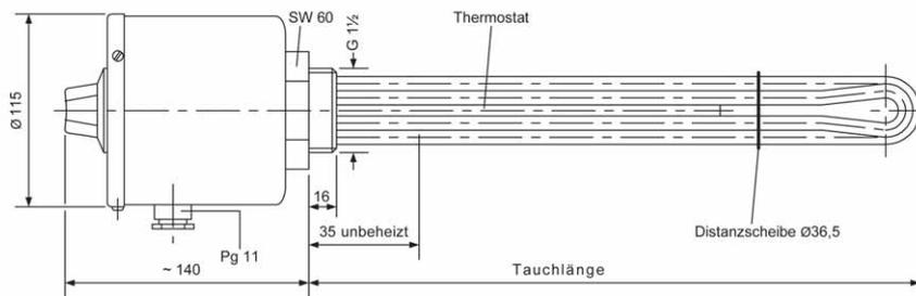
**Sonderanfertigung** Andere Längen, unbeheizte Zonen, Leistungen, Spannungen, Werkstoffe, z. B. Edelstahl sind lieferbar. Thermostat 0 bis 85° C, Schaltdiff. 4 K, 16 A bis 400 V ohne Mehrpreis lieferbar. Doppel-Thermostat 3 x 20 A bis 400 V (Regler 5-85° C, Schaltdiff. 12 K, Begrenzer 110° C) oder Temperatur-Begrenzer 0-110° C, 16 A bis 250 V (bei 2, 3 und 12 kW 1polig, bei 4,5 bis 9 kW 3polig) bitte anfragen.
