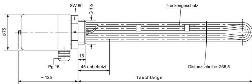
**Einbau** Der Fühler des Trockengeschutzes muß oben liegen. Einbau waagrecht. (Senkrecht nicht zulässig)
