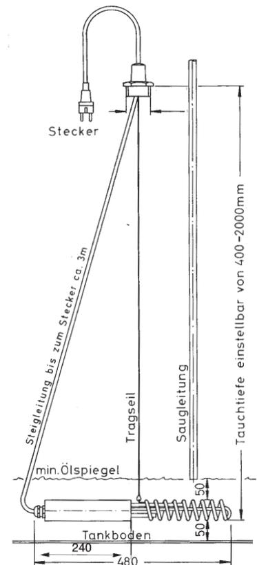
**Einbau** Domdeckel mit Bohrung G 2 versehen, Saugrohr so kürzen, daß die Mindesttauchtiefe gewährleistet ist. Die Tauchtiefe des Tankheizers auf eine Bodenfreiheit von mind. 50 mm einstellen. Den Tankheizer einschrauben. Stecker in Steckdose stecken. Der elektrische Anschluß erfolgt an 230 V Wechselstrom.
