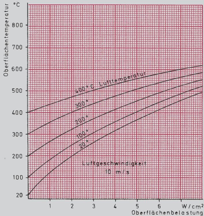
**Tabelle zur Ermittlung der maximalen Oberflächenbelastung und des Rohrmantelwerkstoffes für verschiedene Anwendungsgebiete.**
