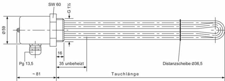
**Sonderanfertigung** Andere Längen, unbeheizte Zonen, Leistungen, Spannungen und Werkstoffe, z. B. Edelstahl, Gewinde G 2 und Schutzart IP 65, sind lieferbar.
