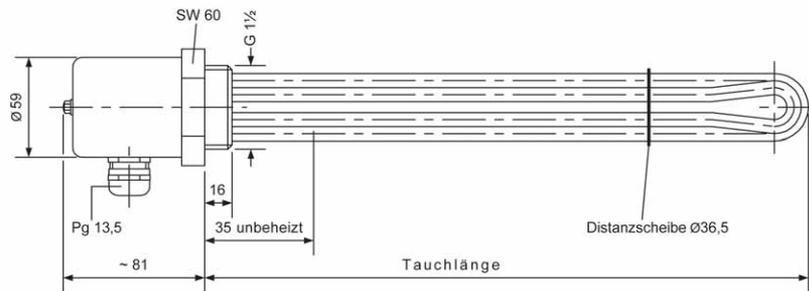
**Sonderanfertigung** Andere Längen, unbeheizte Zonen, Spannungen, Leistungen und alternative Edelstähle W.-Nr. **1.4571** (siehe Seite 1.14), **1.4435, 1.4828, 1.4876, 2.4858**, Nippel G 1 1/2 aus Edelstahl mit eingeschweißten Rohrheizkörpern, Nippel G 2 aus Messing und Schutzart IP 65 sind lieferbar.
